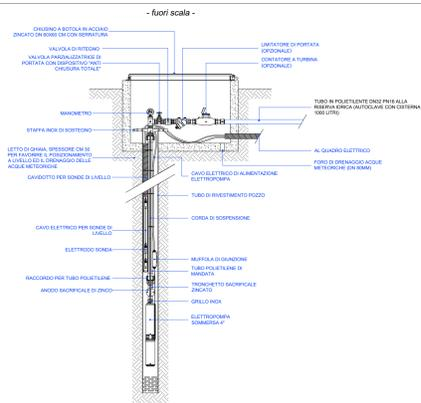
Schema installazione autoclave - Pompa immersa e cisterna 1000 litri
